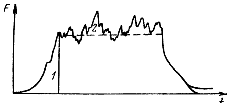
Рис. 74. Осциллограмма отрыва пленки полимера от полупроводника
